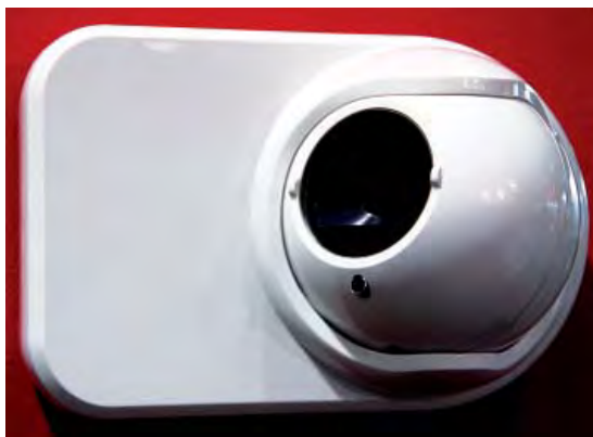
Przykładowa konstrukcja liniowej czujki dymu umożliwiającej obsługę do siedmiu elementów nadawczych 3 . Ruchoma część zawierająca matrycę detektora umożliwia prostsze i bardziej precyzyjne ustawienie wiązek (fot. archiwum NIMOZ)
