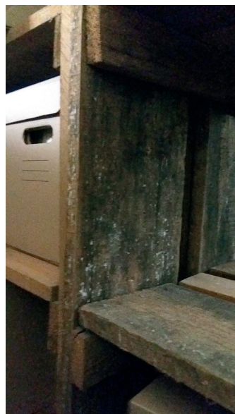
Ryc. 14. (A) Wzrost gnilicy mózgowej ( Coniophora puteana ) na betonowej posadzce; przyczyna: wprowadzenie do magazynu w piwnicy zainfekowanych palet i wysoka wilgotność w pomieszczeniu. (B) Wzrost grzybów pleśniowych w bibliotece; przyczyna: półki wykonane z niedosuszonego, niezabezpieczonego drewna w magazynie na poddaszu. Fot. M. Dyda
