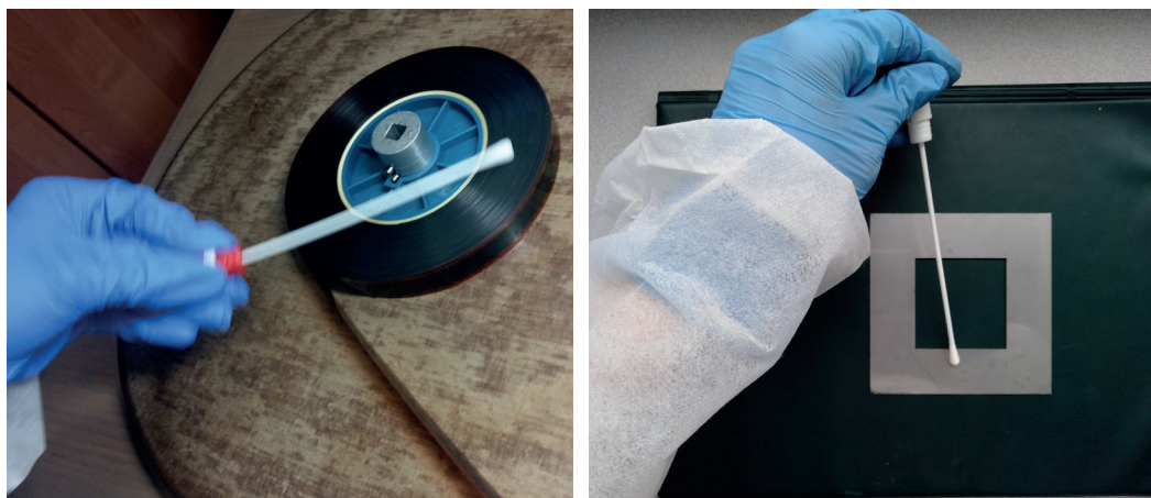
Ryc. 23. Pobieranie próbek z powierzchni obiektu metodą suchego wymazu: (A) z powierzchni filmu oraz (B) z powierzchni okładki, z wykorzystaniem sterylnego szablonu z otworem wewnętrznym 25 cm 2 . Fot. M. Dydka
