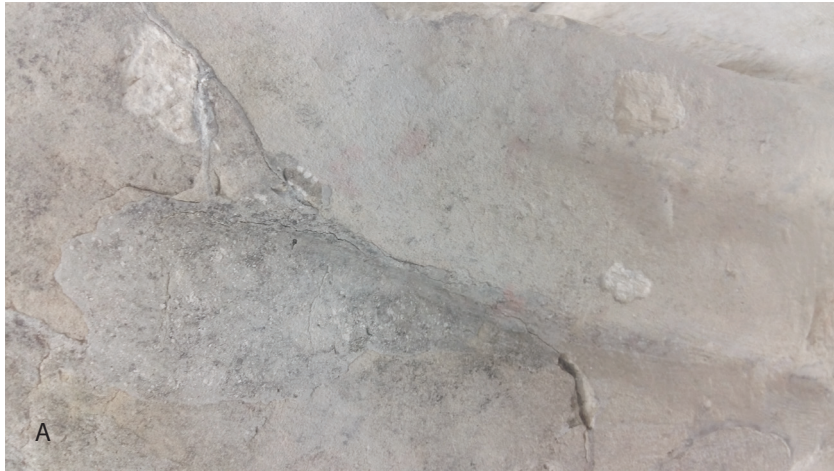
Ryc. 31. Przebarwienia na powierzchni zabytkowej rzeźby kamiennej (A) oraz wyizolowane kolonie bakterii odbarwiające podłoże z węglanem wapnia (B, C). Fot. M. Dyda
