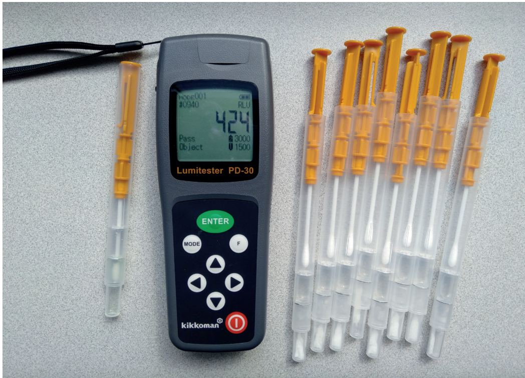
Ryc. 30. Luminometr oraz wymazówki do pobierania próbek w celu określenia stężenia ATP na powierzchni. Na zdjęciu wymazówki przed wykonaniem pomiaru (8 szt.) oraz próbka po pomiarze luminometrycznym (1 szt., wynik pomiaru widoczny na wyświetlaczu urządzenia). Fot. M. Dydą
