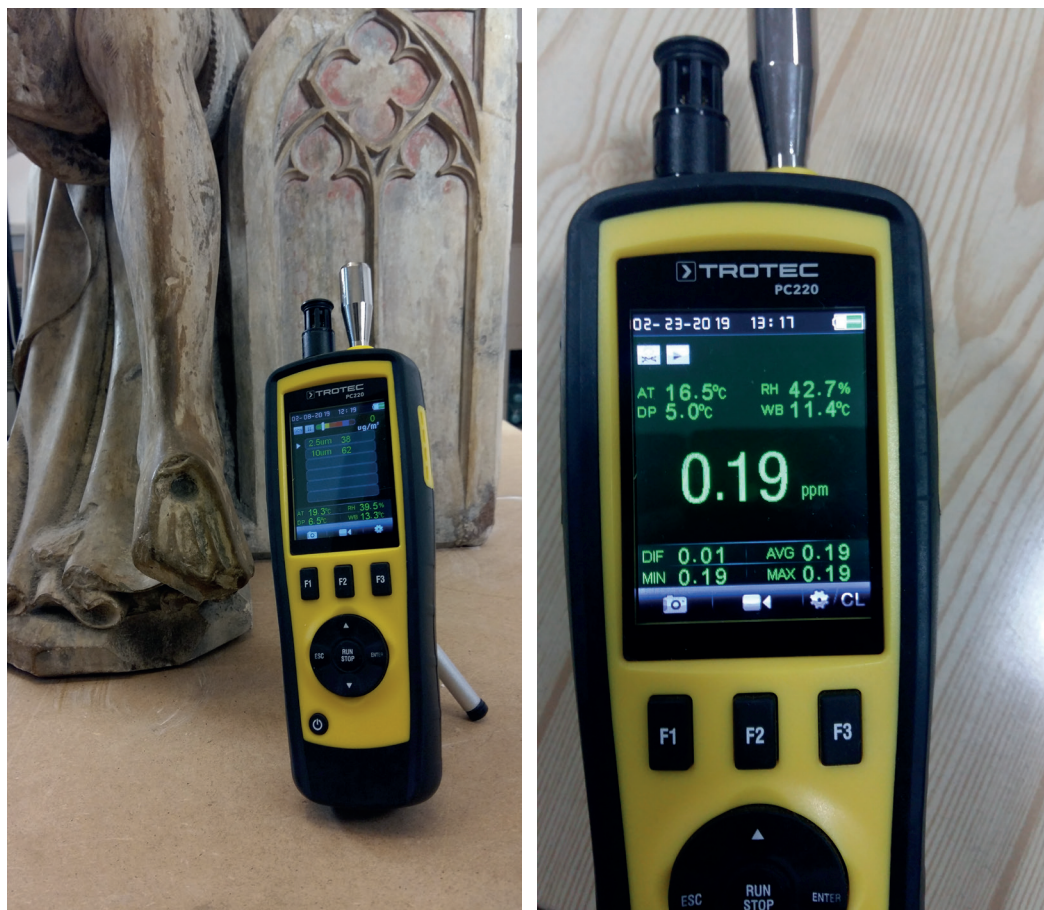
Ryc. 15. Pomiar stężenia (A) pyłów zawieszonych oraz (B) formaldehydu w powietrzu w pracowni konserwatorskiej. Równoległy pomiar temperatury [AT] i wilgotności względnej powietrza [RH]. Fot. M. Dyda
