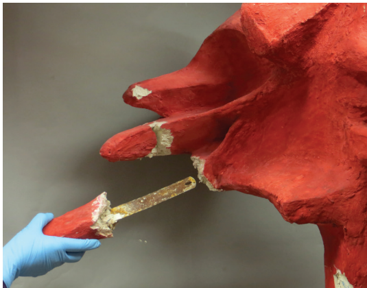
Fot. 11. Rzeźba gipsowa Aliny Ślesińskiej. Artystka użyła metalowych brzeszczotów jako szkieletu konstrukcyjnego rzeźby.
