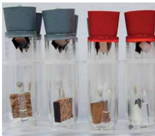
Fot. 10. Zestaw do przeprowadzania testów Odde'go materiałów stosowanych w magazynach w Muzeum Narodowym w Krakowie.
