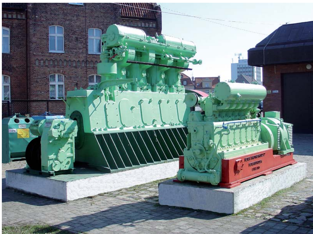
Fot. 3. Zabytkowe silniki na placu magazynowym Narodowego Muzeum Morskiego w Gdańsku – na pierwszym planie zespół prądotwórczy z silnikiem spalinowym z m.s. „Batory”, na drugim planie pomocniczy silnik spalinowy z 1913 roku z wyposażenia m.s. „Romuald Traugutt” (fot. Archiwum NMM)
