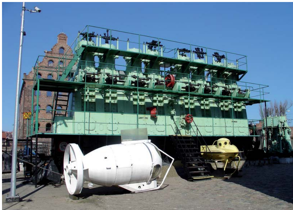
Fot. 4. Silnik wysokoprężny zbudowany w 1913 roku stanowił napęd statku „Romuald Traugutt” (wcześniej duński „Annam”) na placu magazynowym przy głównej siedzibie NMM (fot. Archiwum NMM)
