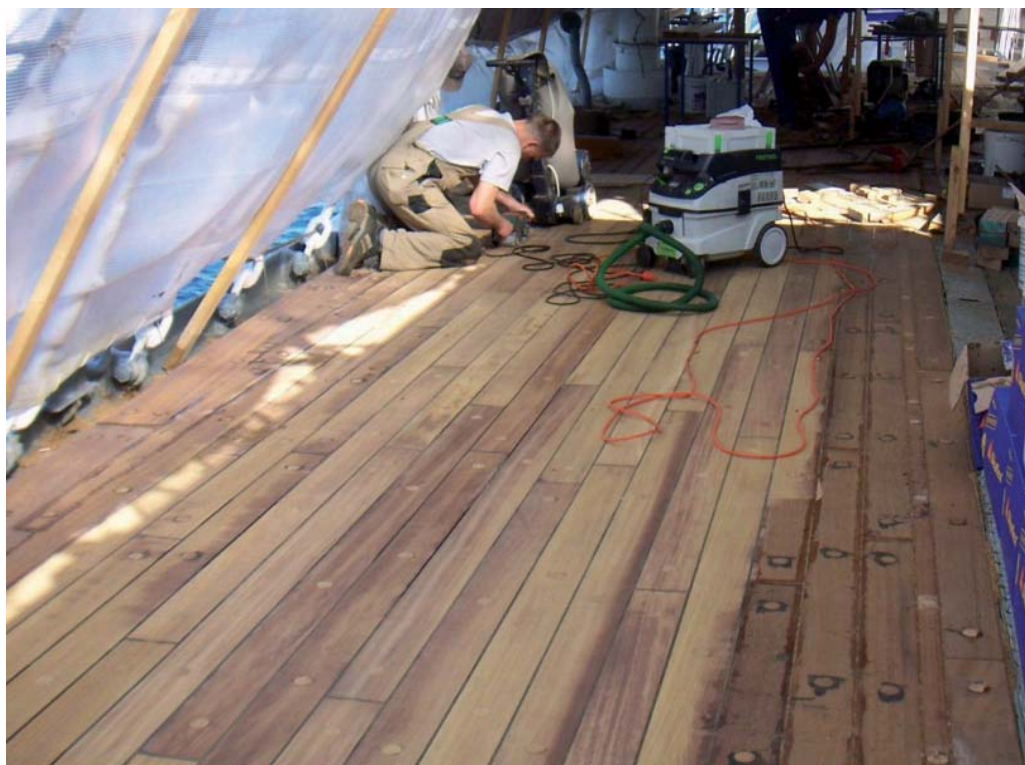
Fot. 10. Wymiana pokładu na Statku–Muzeum „Dar Pomorza” (fot. J. Litwin)
