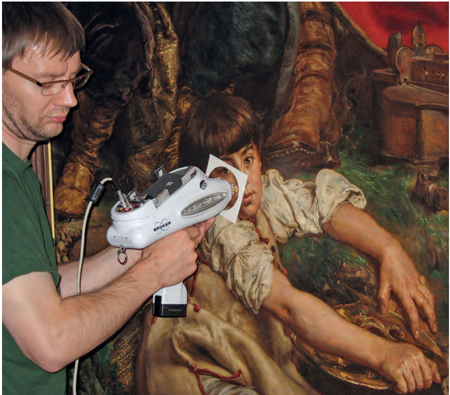
il. 4. Autor w trakcie badań przenośnym spektrometrem XRF obrazu Wernyhora (1884) Jana Matejki.
