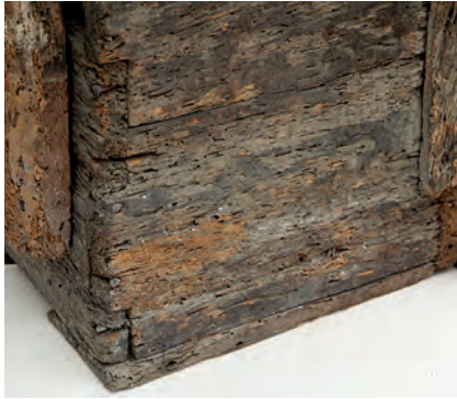
il. 3. Erozja drewna i ślady po owadach. Fragment włoskiej skrzyni-lawy z XIV w.
