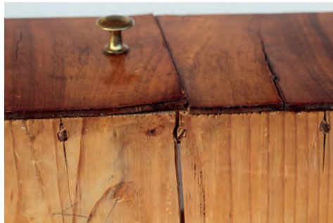
il. 1. Szufladka sekretery z okresu biedermeier, z grubą okleiną na licu i ręcznie wykonanymi kołkami stożkowymi mocującymi dno, z widocznymi destrukcjami (pęknięcia, uschnięcia, wypaczenia i częściowe odklejenia).
