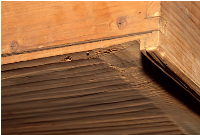
il. 4. Ślad wyrównywania dna szuflady (komody z ok. 1820 r.) dłutem lub strugiem z półokrągłym nożem, zw. śrupakiem
