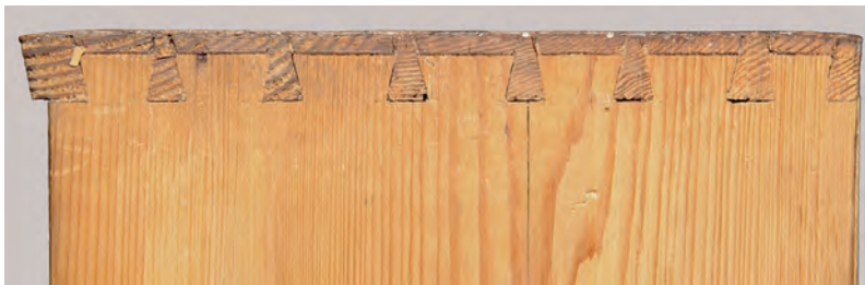
il. 5. Ślady znacznika przy ręcznie wykonanych wczepach skośnych półkrytych szuflady z ok. 1820 r.
