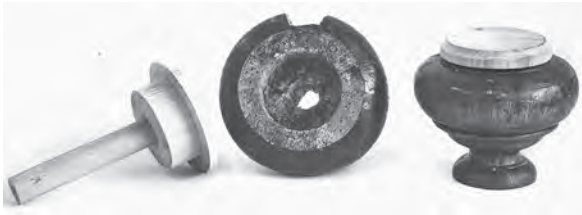
il. 7. Kuliste nogi szafy sieniowej silnie zerodowane i osłabione przez owady, wzmocnione toczonym rdzeniem, wklejonym w wydrążony otwór o zróżnicowanej średnicy, przenoszący znaczny ciężar mebla.
