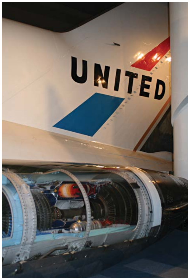
7. Fragment samolotu pasażerskiego Boeing 727, linii lotniczych United, z przekrojem przez silnik
