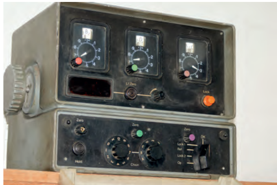
15. Klasyczny odbiornik systemu DECCA; aparaty tego systemu przez pół wieku stanowiły standard w praktyce nawigacyjnej floty, ze zbiorów MNS
