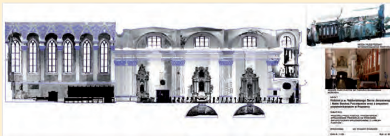
6. Kościół pw. Najświętszego Serca Jezusowego i Matki Boskiej Pocieszenia wraz z zespołem poddominikańskim w Poznaniu – przekrój przez kościół i prezbiterium opracowany na podstawie ortofotografii wygenerowanej z „chmury punktów”
