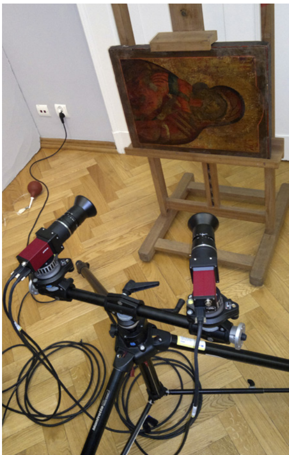
10. Badanie XVIII-wiecznej ikony za pomocą Cyfrowej Korelacji Obrazów – nowej metody badań nieinwazyjnych (2011)
