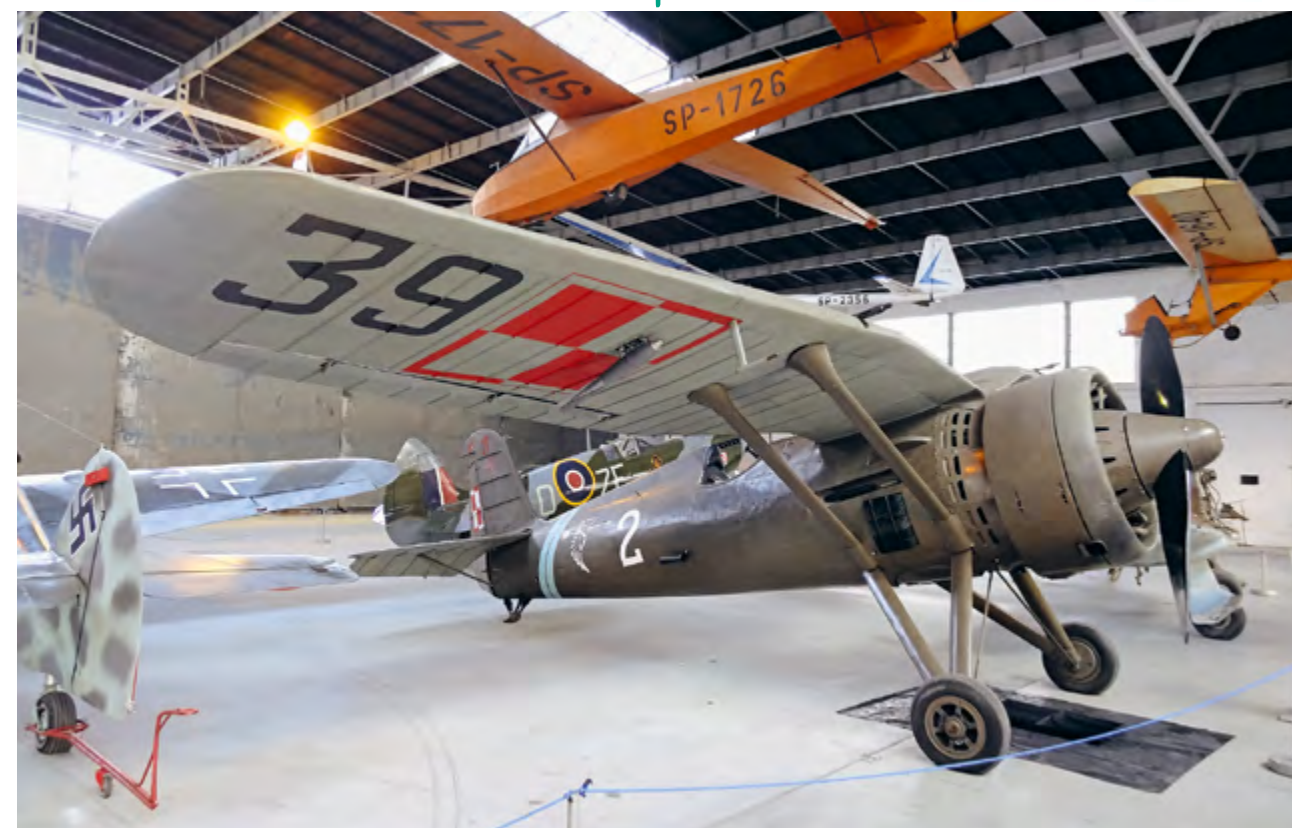
↑ 145. Samolot myśliwski PZL P.11, zaprojektowany w Państwowych Zakładach Lotniczych na początku lat trzydziestych XX w. Był to podstawowy myśliwiec polskiego lotnictwa wojskowego w kampanii wrześniowej 1939 r., fot. Michał Mackiewicz, Muzeum Lotnictwa Polskiego w Krakowie
