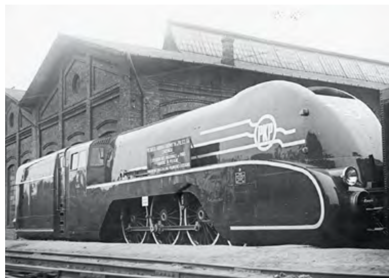
↑ 125. Parowóz pośpieszny PM36 z otuliną aerodynamiczną projektu Kazimierza Zembrzuskiego, Międzynarodowa Wystawa Sztuki i Techniki w Paryżu, 1937, Narodowe Archiwum Cyfrowe
