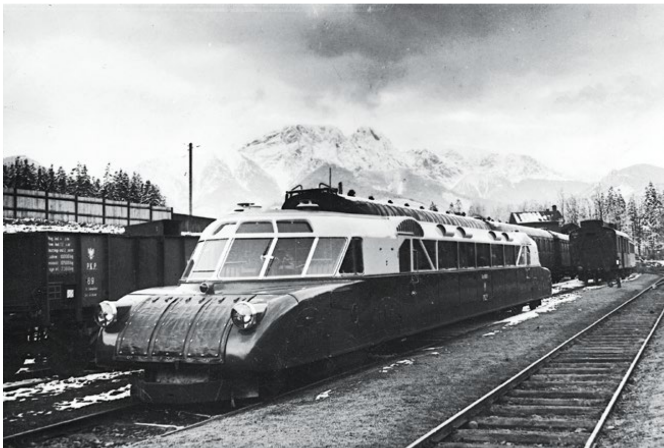
↑ 129. Wagon spalinowy „Luxtorpeda”. Rozwijał prędkość do 115 km/h i woził zamożnych pasażerów z Warszawy do Łodzi, Krakowa i Zakopanego. Podobne wozy obsługiwały połączenia ze Lwowa przez Kraków do Zakopanego, Narodowe Archiwum Cyfrowe
