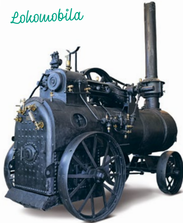
↑ 139. Lokomobila typ LN z 1924 r., urządzenie służące jako napęd maszyn rolniczych, wyprodukowana przez zakłady H. Cegielski Spółka Akcyjna w Poznaniu, Muzeum Narodowe Rolnictwa i Przemysłu Rolno-Spożywczego w Szreniawie
